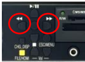
図 25 前面 巻戻しボタン / 早送りボタン
