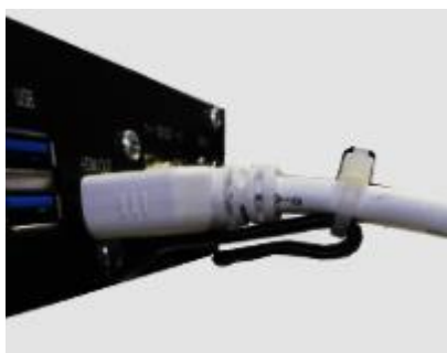
図 59 背面 抜け防止ワイヤー 固定
