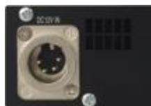
図 7 背面 12V DC 電源入力端子 XLR-4P
