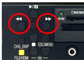
図 24 前面 巻戻しボタン / 早送りボタン
