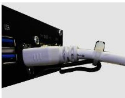
図 33 背面 抜け防止ワイヤー 固定
