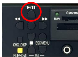
図 23 前面 一時停止(再生)ボタン
