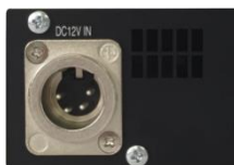
図 7 背面 12V DC 電源入力端子 XLR-4P
