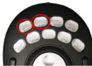
(図 25 コントローラ SHIFT+REC STOP)
