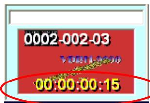
プレイリスト上に尺が 20 フレーム以下のクリップを登録した場合、そのクリップの Duration の表示が黄色になります。
