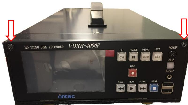
前面パネルを閉めて、矢印部分のビスを+ドライバーで締め付けます。
