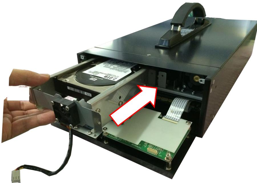
新しいディスクユニットをスロットに挿入して、奥に押し込みます。
