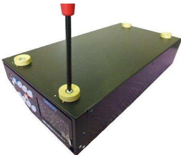
VDRH-4000P の裏面に付属ネジを使用して固定してください。
