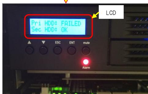
RAID ユニットの LCD を見て、どちらの SSD を交換すべきか確認します。
