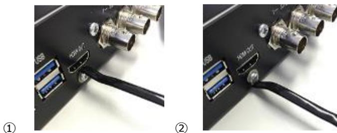
図 59 背面 抜け防止ワイヤー 装着
