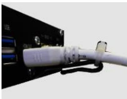
図 60 背面 抜け防止ワイヤー 固定
